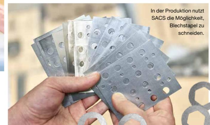
In der Produktion nutzt SACS die Möglichkeit, Blechstapel zu schneiden.
